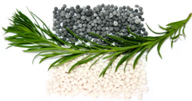
**ГРАНУЛИРОВАННОЕ ПЕНОСТЕКЛО** – полностью неорганический теплоизоляционный материал, получаемый при термообработке мелкомолотого стекла с пенообразователем при 700-800°C.
